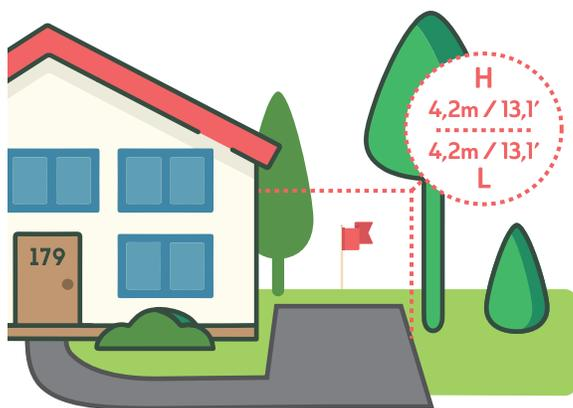
\* Dans la mesure du possible, le camion restera sur la voie publique. Si ce n'est pas possible, la voie d'accès à la propriété doit être dégagée à une hauteur et une largeur de 4,2 mètres (13,1 pieds).
